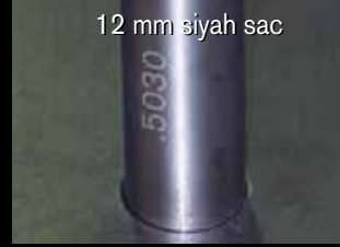
True Hole teknolojisi ile 12 mm delik kesimi
